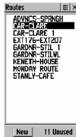
Списък с наличните маршрути. Два от тях са копирани (имат "1" след името)
